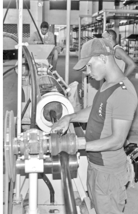
La extrusora trabaja por un sistema de aire y presión en un proceso de calentamiento de la materia prima a altas temperaturas
