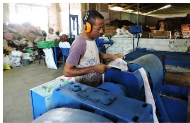
En la paletizadora se procesa el polietileno de baja densidad (nailon) para la confección de mangueras en la extrusora
